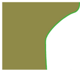
Überhängend, so dass regengeschützte Bereiche entstehen
